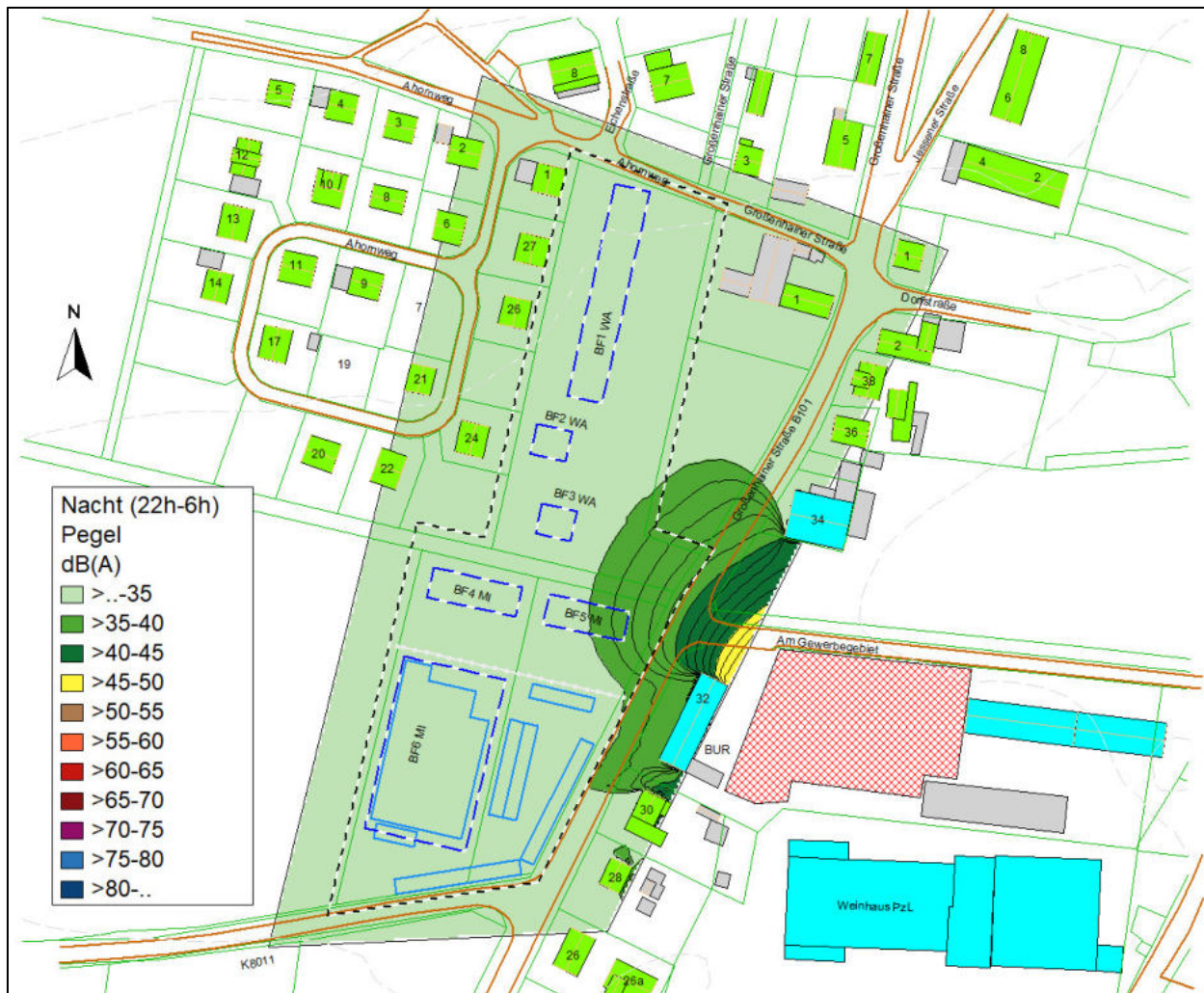
Abbildung 13: Raster Beurteilungspegel Gewerbe BUR im Nachtzeitraum (Rasterhöhe relativ 3 m über Grund, Rasterschrittweite 1 m)
