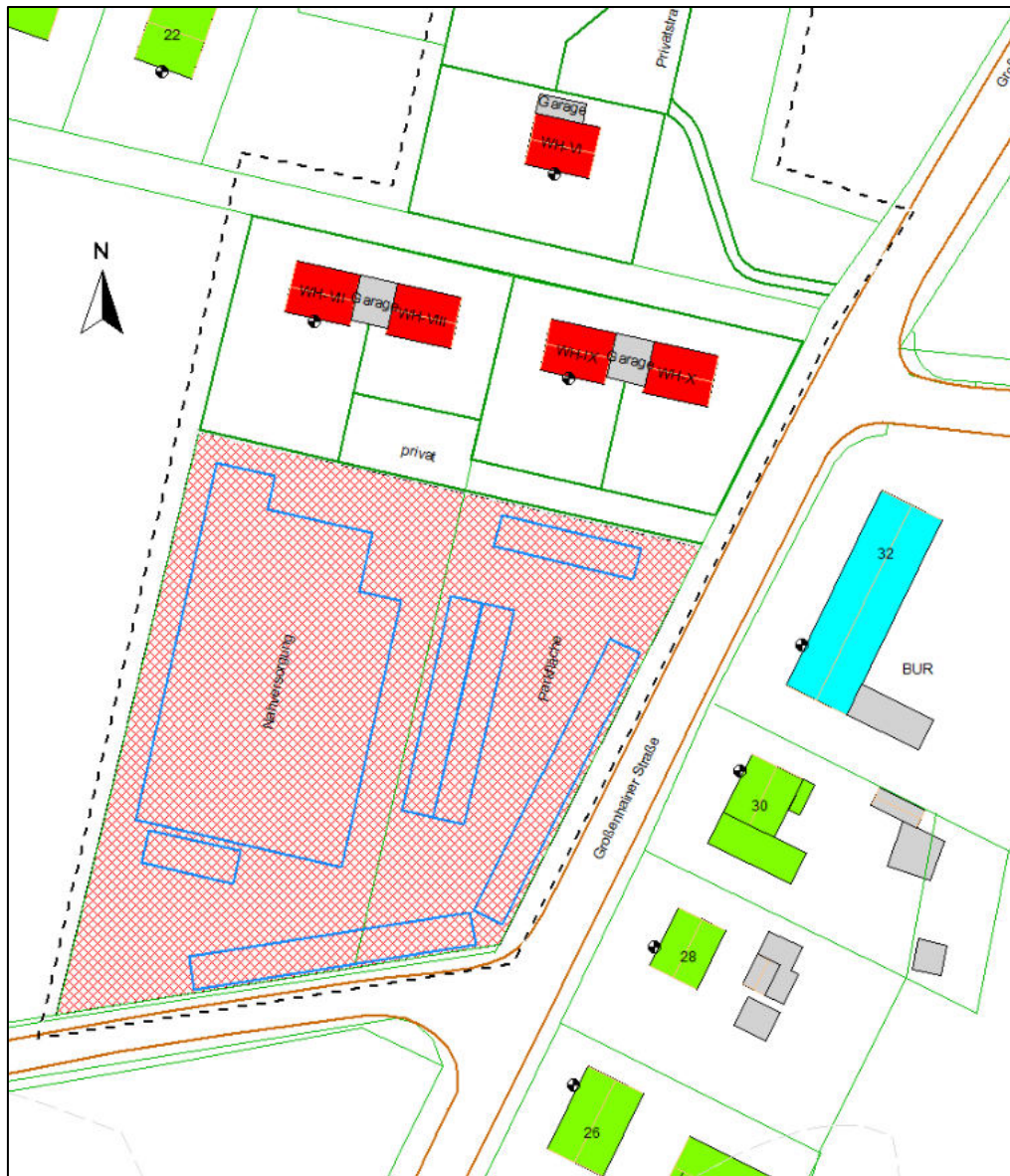
Abbildung 19: LP Nahversorgung – Flächenschallquelle zur Ermittlung des zulässigen flächenbezogenen Schallleistungspegels
