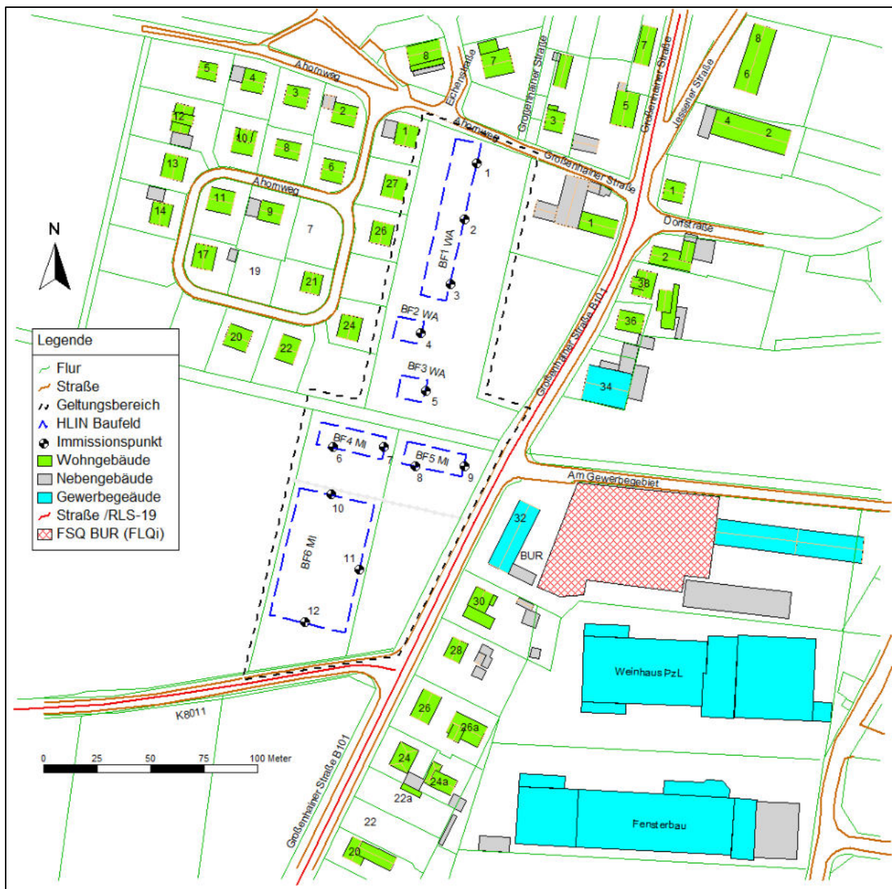
Abbildung 7: Lageplan (Rechenmodell) Geltungsbereich des B-Planes mit der Lage der Immissionsorte auf den Baugrenzen sowie der Umgebungsbebauung
